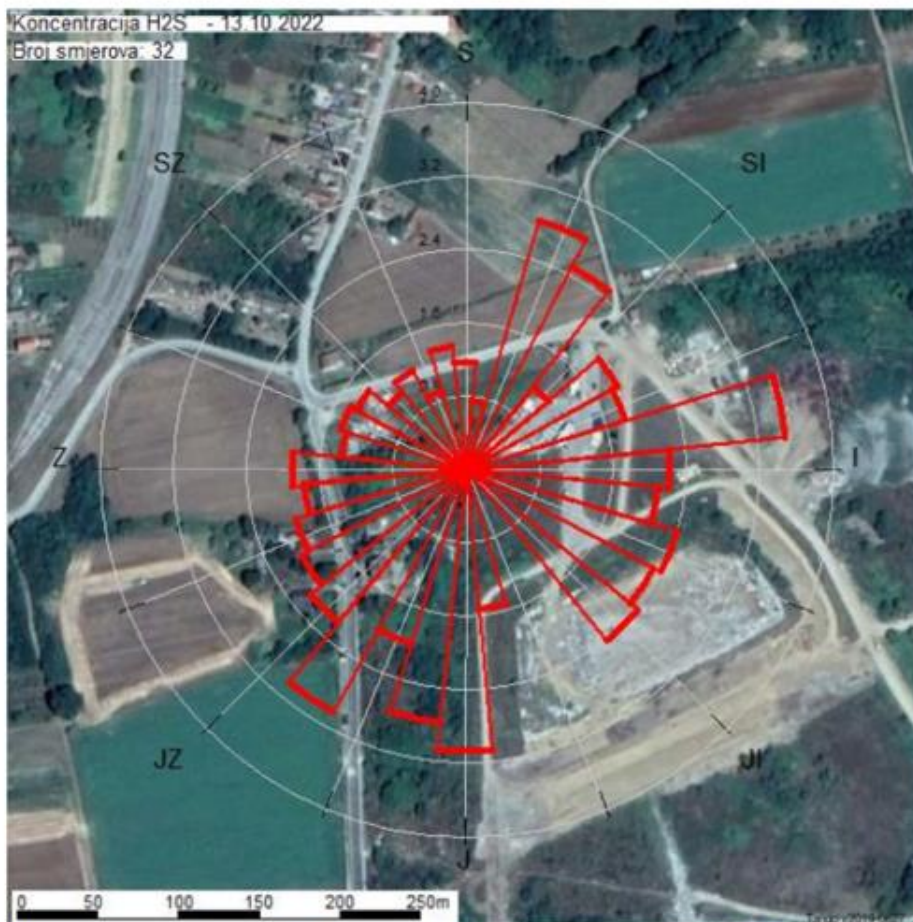
Slika 13. Prikaz srednjih imisijskih koncentracija H_2S u odnosu na smjer vjetra na lokaciji Odlagalište Staro Valpovo za razdoblje mjerenja 27.9. – 13.10.2022. ( \mu g/m^3 ) Izvor: Izvješće br. A053-22, DVOKUT EKRO d.o.o., studeni 2022.)
