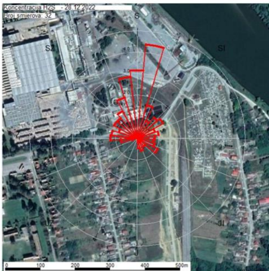
Slika 11. Prikaz srednjih imisijskih koncentracija H 2 S u odnosu na smjer vjetra na lokaciji južno od UPOV Belišće za razdoblje mjerenja 10.12. – 28.12.2022. (u \mu\text{g}/\text{m}^3 ) Izvor: Izvješće br. A067-22, DVOKUT EKRO d.o.o., siječanj 2023.)
